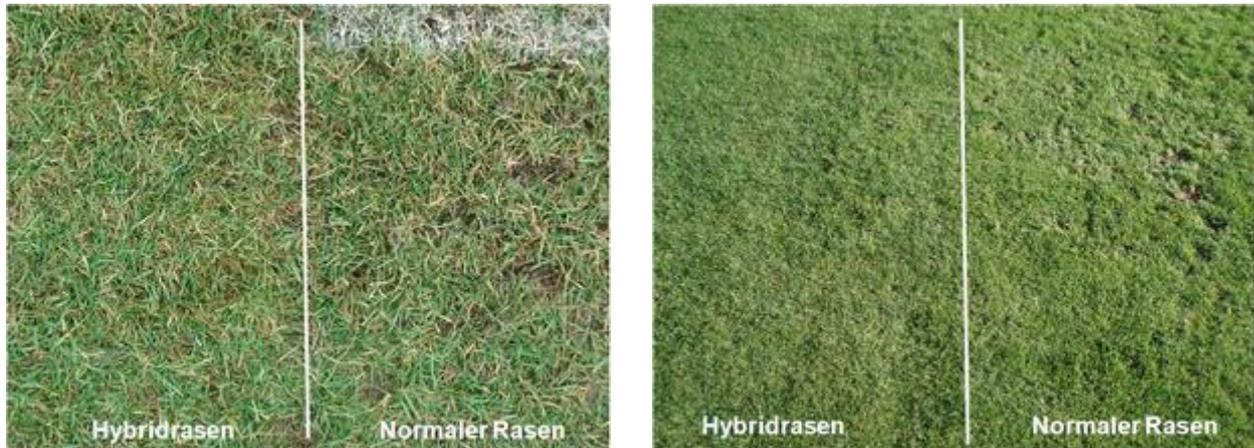
Abb. 6: Vergleich bei intensiver Belastung: im Versuch mit Stollenwalze (links), bei Nutzung durch Training (rechts)
