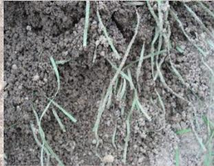
Die Rasentragschicht wird mit 18 cm langen, zufällig verteilten Kunststofffasern vermischt.
